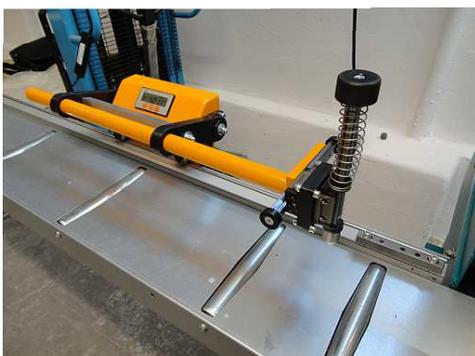
1. Herstellen des Abstands zur 1. Bohrung mit Hilfe der **Absteckvorrichtung „mts-Z“**
